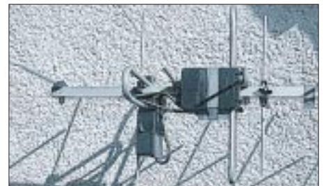
Bild 4: Elemente bei einer 70-cm-Kreuzyagi um \lambda/4 auf dem Tragrohr versetzt
