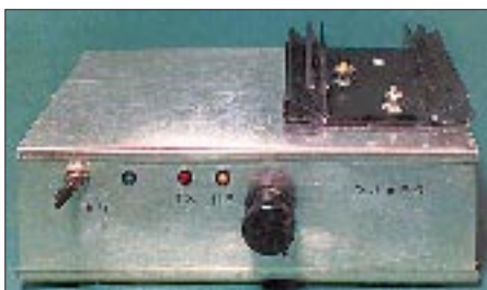
Bild 14: Ein kompletter Sende/Empfangs-Umsetzer im Weißblechgehäuse mit aufgesetzter Endstufe Fotos: DJ9FG
